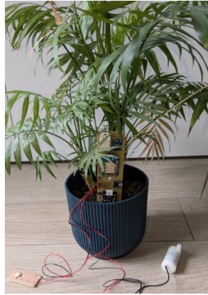
Abbildung 2 – Node, beispielhaft ohne Anschlüsse für Wasser und Licht.
